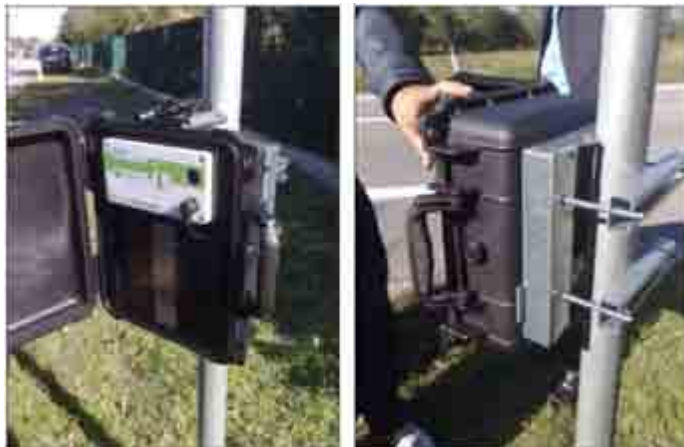
Figura 34 – RADAR SDR-Easydata – Esempio di installazione
